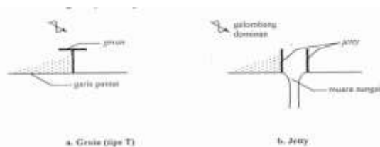
Gambar 2. Beberapa bangunan penahan sedimen pantai
