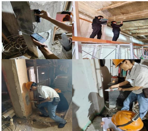
Gambar 6. Pengujian Kekuatan Struktur Beton Menggunakan Hammer Test
