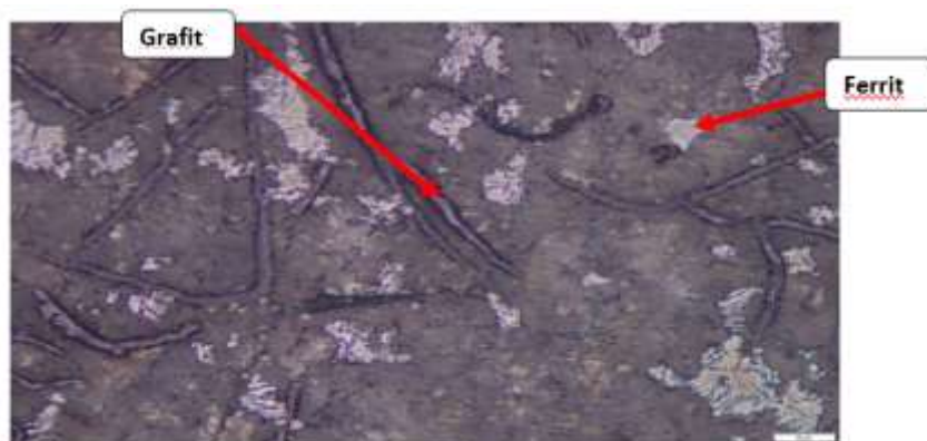
Gambar 31. Cold Weld, Daerah HAZ Dengan Pembesaran 500x
