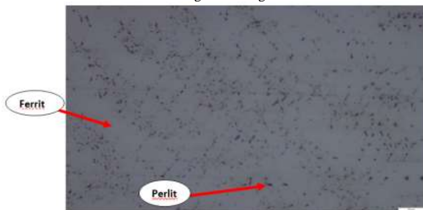
Gambar 26. WM, Normal, Daerah Logam Las dengan Pembesaran 500x
