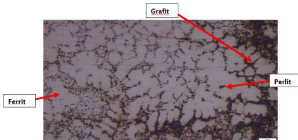
Gambar 27. WM, Cold Weld, Daerah Logam Las dengan Pembesaran 500x
