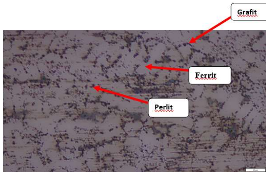
Gambar 23. WM, Cold Weld Daerah Logam LAS dengan pembesaran 500x
