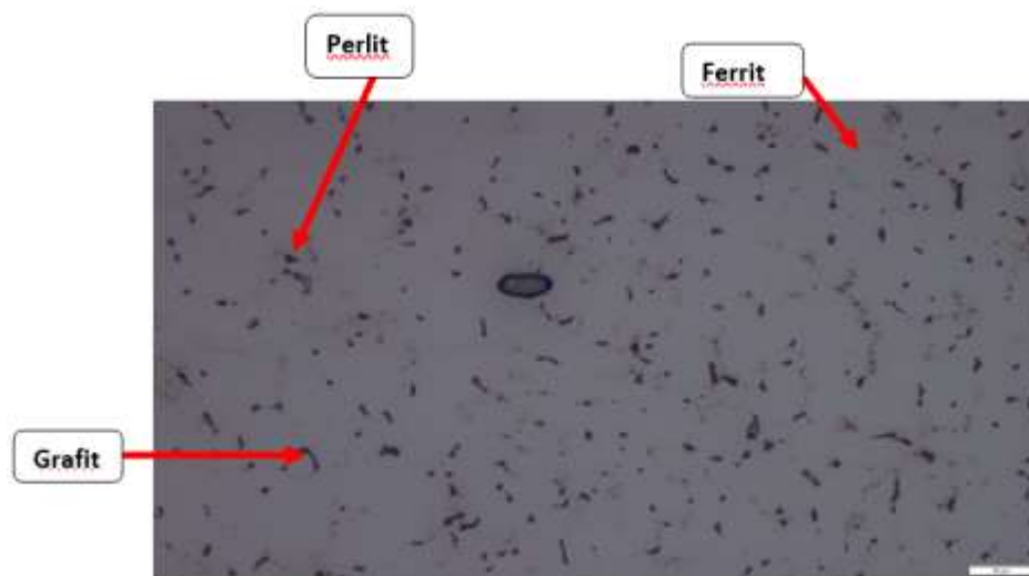
Gambar 25. WM. Cold Weld, Daerah Logam Las dengan Pembesaran 500x
