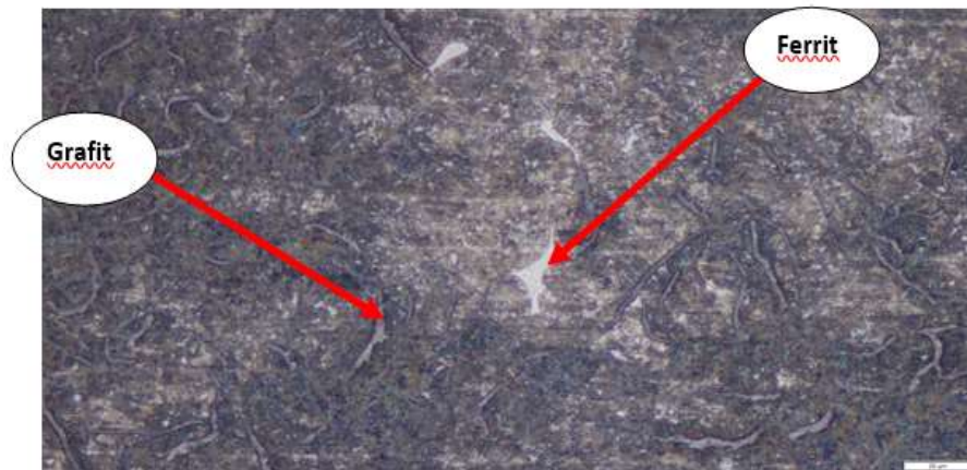
Gambar 33. Cold Weld, Daerah HAZ dengan Pembesaran 500x
