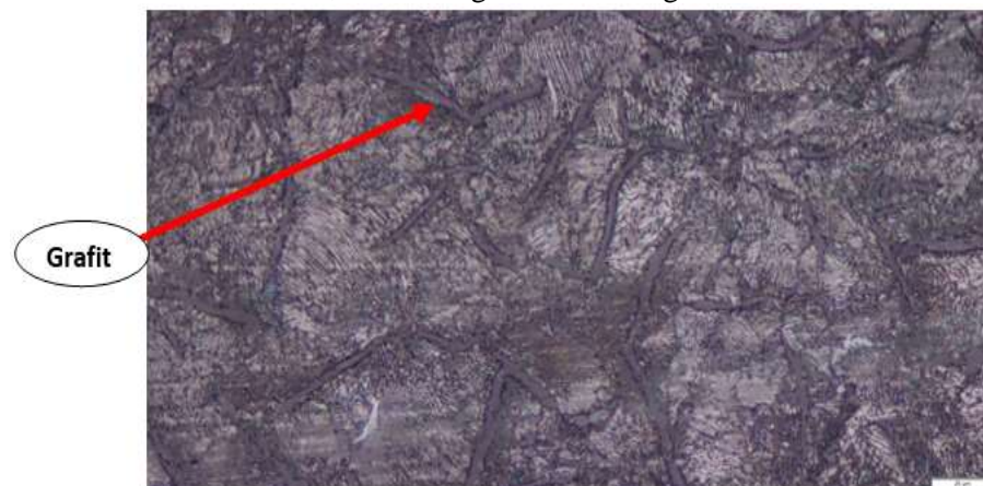
Gambar 35. Cold Weld, Daerah Logam Induk dengan Pembesaran 500x
