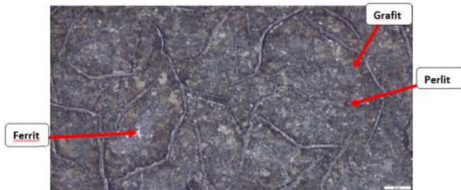
Gambar 30. Normal, Daerah HAZ Dengan Pembesaran 500x
