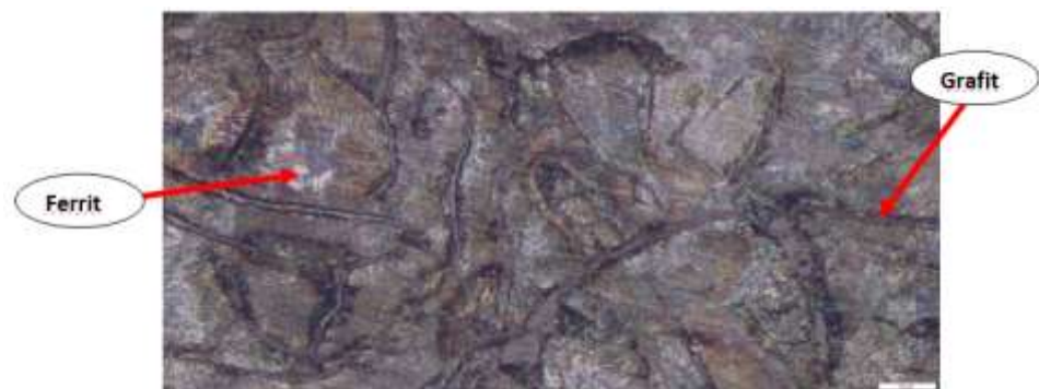
Gambar 37. Cold Weld, Daerah Logam Induk dengan Pembesaran 500x
