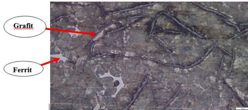
Gambar 28. Normal, Daerah Haz dengan Pembesaran 500x
