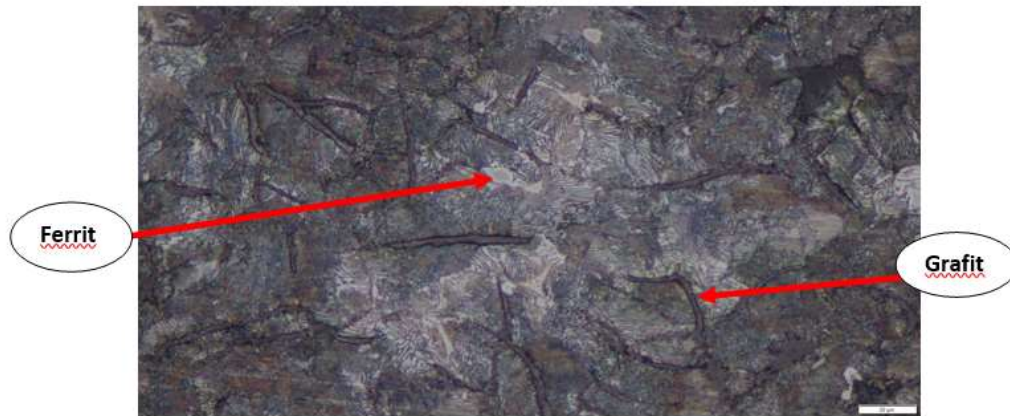
Gambar 39. Cold Weld, Daerah Logam Induk Dengan Pembesaran 500x
