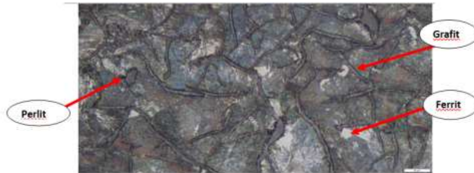
Gambar 36. Normal ,Daerah Logam Induk Dengan pembesaran 500x
