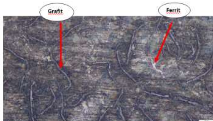
Gambar 32. Normal, Daerah HAZ dengan Pembesaran 500x
