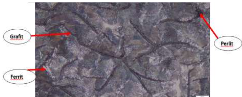
Gambar 38. Normal, Daerah Logam Induk Dengan Pembesaran 500x
