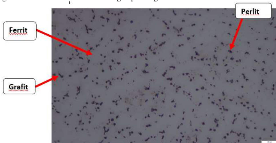
Gambar 24. WM, Normal, Daerah logam Las dengan Pembesaran 500x
