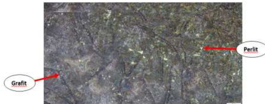
Gambar 34. Normal, Daerah logam Induk dengan Pembesaran 500x
