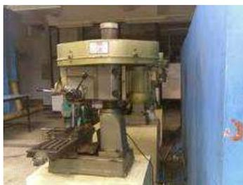
Gambar 5. Mesin Bor Tegak
