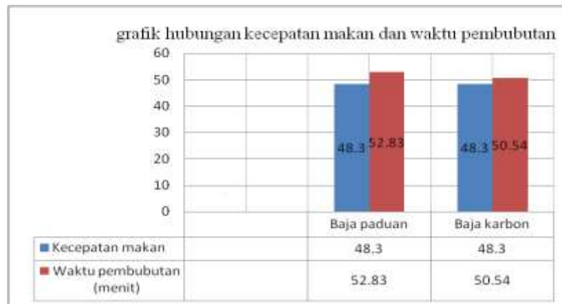
Gambar 3.3 Hubungan antara kecepatan makan dengan waktu pemotongan
