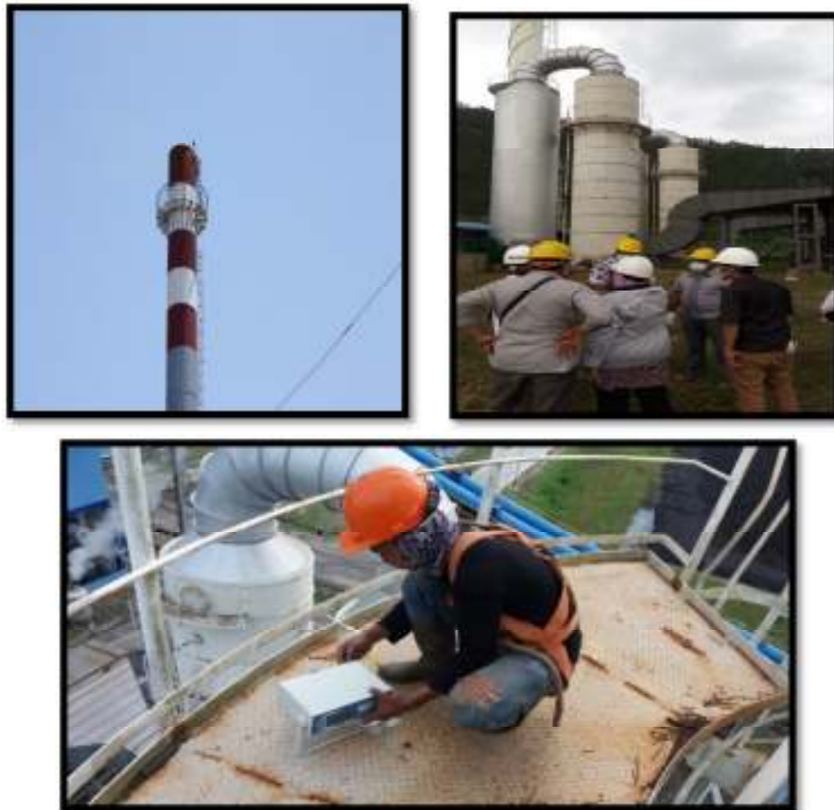
Gambar 7. Pengambilan Sampel Gas Emisi Cerobong PLTU Holtekamp
