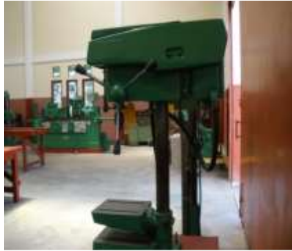
Gambar 1. Mesin bor meja
