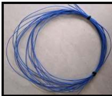
Gambar 3 Termokopel Sumber : (Lab EBT Teknik Mesin Universitas hasanuddin)
