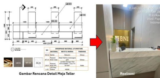
Gambar 4. Ketidaksesuaian Realisasi dan Gambar Rencana serta Spesifikasi Material Sumber: CV Lixal Art, 2024 dan CV Archdeco, 2025
