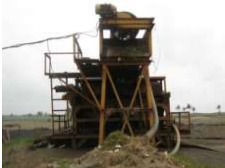
Gambar 4. Pemisahan material pengotor pada sieve trommol
