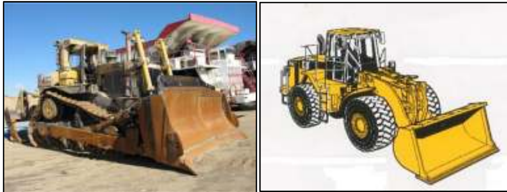
Gambar 2. Alat mekanis bulldozer dan Whell Lader yang digunakan untuk pekerjaan perbaikan kondisi tanah.
