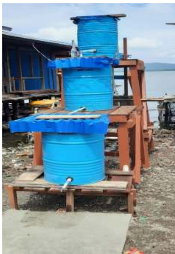
Gambar 3 : Hasil Pembuatan Instalasi Teknologi Filtrasi Air bersih
