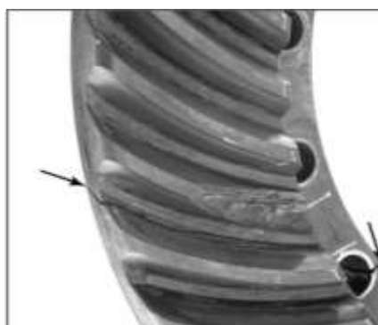
Gambar 7. Kondisi eccentric gear yang mengalami kegagalan
