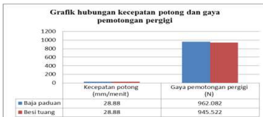
Gambar 3.6. Grafik Hubungan antara kecepatan potong dengan gaya pemotongan pergigi
