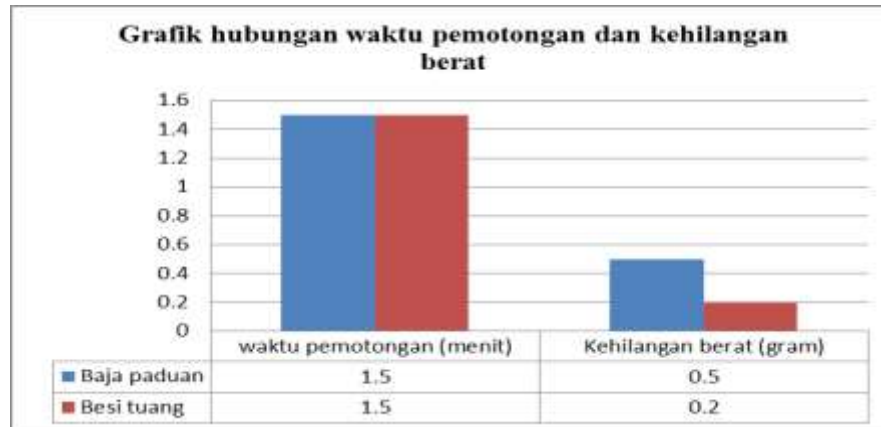
Gambar 3.7 Hubungan antara waktu pemotongan dan kehilangan berat
