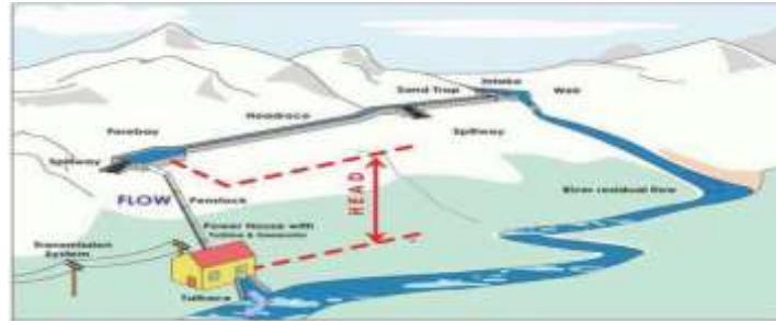
Gambar 5. Prinsip kerja pembangkit listrik bertenaga air
