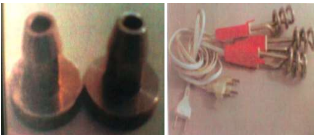
Gambar 3.3 Sirip Kerucut dan elemen pemanas (Sumber: Lab mekanika fluida Teknik Mesin)
