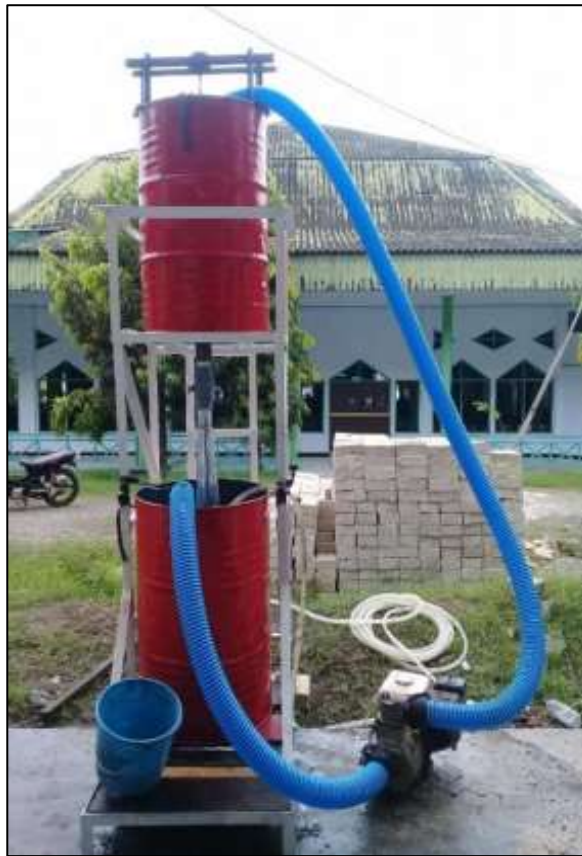
Gambar. 2.2. Desain turbin type propeller sebagai pembangkit listrik tenaga air.
