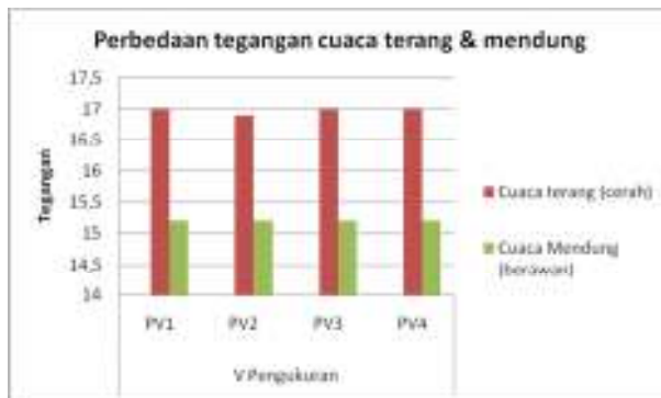
Gambar 8. Grafik perbandingan rata-rata tegangan modul PV pada cuaca cerah dan mendung.
