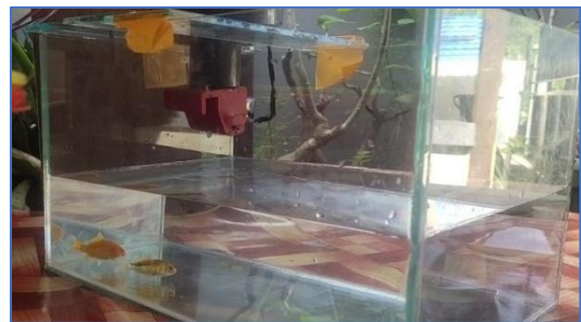
Gambar 3. Proses Motor Servo Mengeluarkan Pakan Ikan Secara Otomatis
