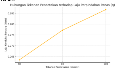
Gambar 10. Hubungan Tekanan Pencetakan Terhadap Laju Perpindahan Panas
